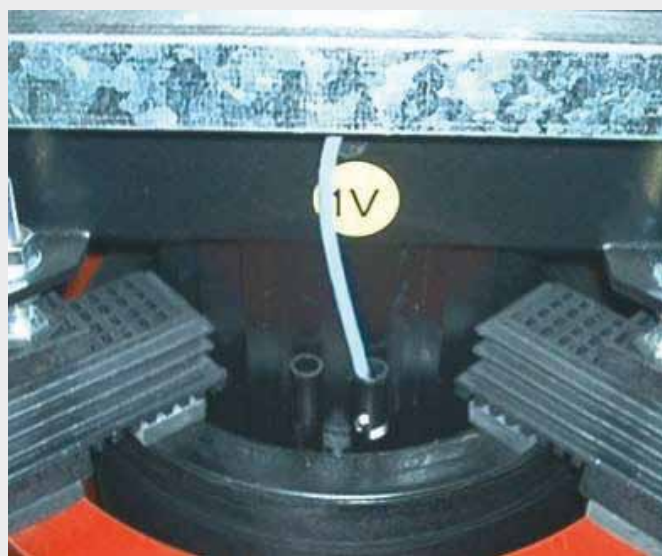
Датчик РТС для контроля температуры
