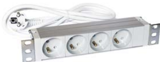
Блок розеток 10" x 1 U, 4 розетки 2P+Z, номинальное напряжение 230 В AC, номинальный ток 10 А, кабель 1,8 м с универсальной вилкой, алюминиевый анодированный корпус
