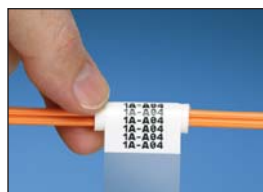
Наденьте муфту LabelCore™ на кабель
